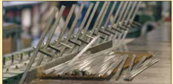
12. Aluminium profielen voorgeboord en op maat gemaakt
