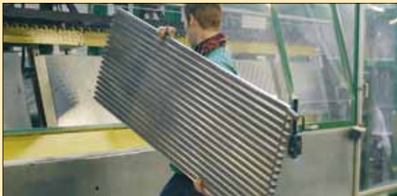
15. Geassembleerde matdelen worden machinaal op maat gemaakt
