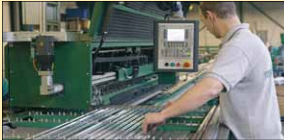
11. Aluminium profielen worden automatisch van gaten voorzien
