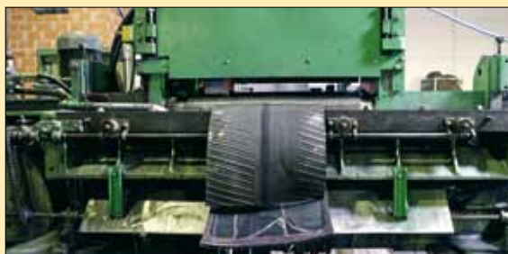
4. Na het verwijderen van het loopvlak en binnenvlak is de strook op de juiste dikte
