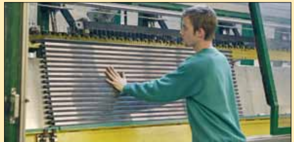
16. Ook het vastzetten van de staaldraad gaat machinaal
