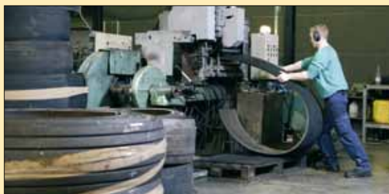
2. Verwijderen van het loopvlak
