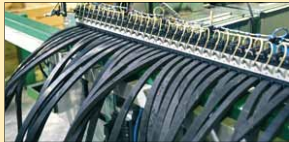
6. Invoer in de machine om het nylonoppervlak uit te borstelen
