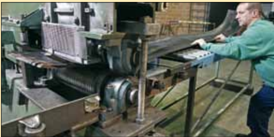
5. Kern van de band wordt in stroken gesneden
