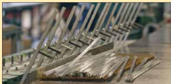
12. Aluminium profielen voorgeboord en op maat gemaakt
