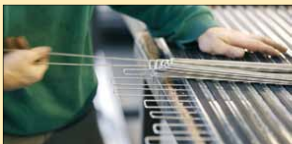
13. Assembleren van rubberstroken en aluminium profielen
