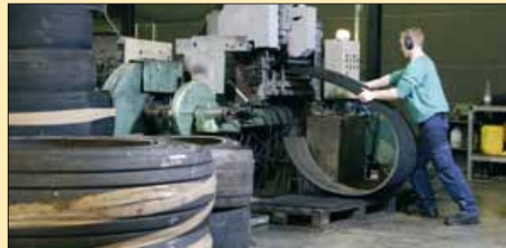
2. Verwijderen van het loopvlak
