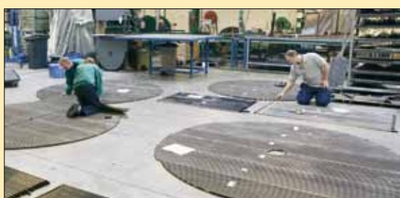
19. Alle maten worden in de werkplaats uitgelegd en nagemeten
