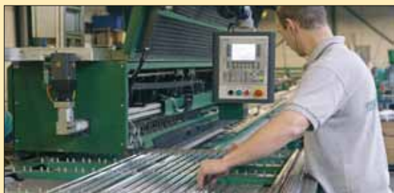
11. Aluminium profielen worden automatisch van gaten voorzien
