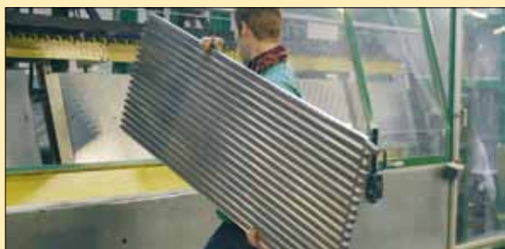
15. Geassembleerde matdelen worden machinaal op maat gemaakt
