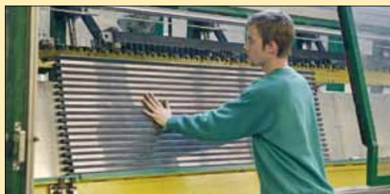
16. Ook het vastzetten van de staaldraad gaat machinaal
