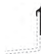
Afdichtingsrubber (Roval 152010) Voor de afdichting van de achterzijde van waterslagen
