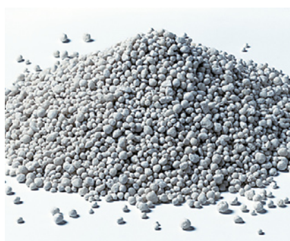
Het glasgranulaat wordt met bindmiddel tot de StoReno plaat gevormd.
