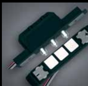
Voedingspanning- en contactoverbrenging via duurzame, hardverzilverde drukcontacten
