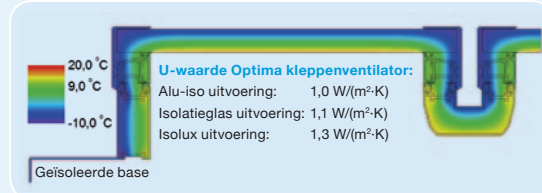
Afbeelding illustreert de warmtestroom met een temperatuurverloop van buiten -10 °C tot binnen 20 °C. Flixo U-waarden worden bepaald volgens EN ISO 10077-2
