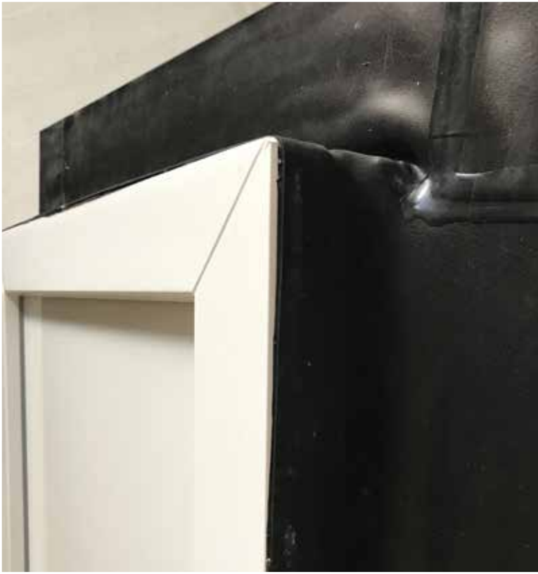
Testopstelling met EPDM kader aan de Universiteit Gent
